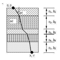
всадник в наиболее «плотной» среде — т.е. с наибольшим коэффициентом проходимости; все остальные углы будут заведомо больше него). Отыскать же нужный угол (а точнее, синус нужного угла — непосредственно угол на самом деле вычислять и не нужно) можно с помощью бинарного поиска — разделяя каждый раз диапазон возможных значений пополам и сокращая область поиска.
